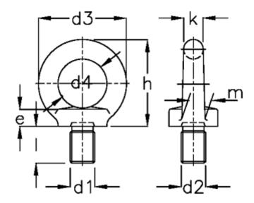
$$\begin{array}{ll} d1 = M16 & K = 14 \\ d2 = 35 & I = 27.0 \\ d3 = 63 & m = 16 \\ d4 = 35 & \end{array}$$
